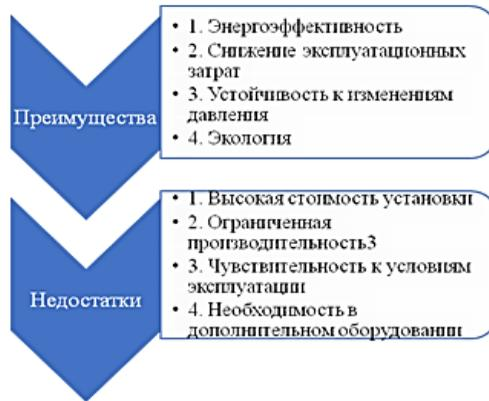
Рис. 1. Схема эффективности использования детандеров в системах газораспределения
