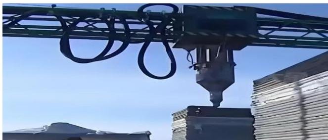
Рис. 2. Роботизированная рука для 3D-печати
