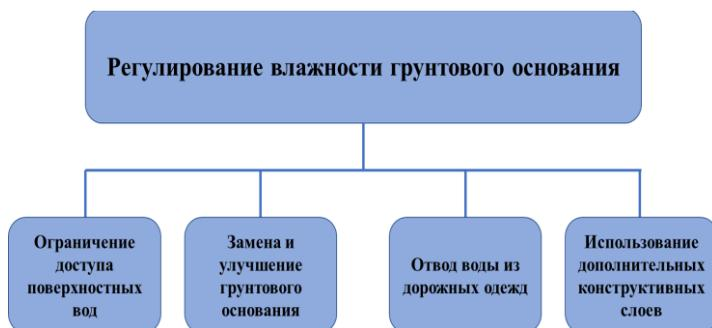
Рис. 3. Методы регулирования увлажнения грунтового основания
