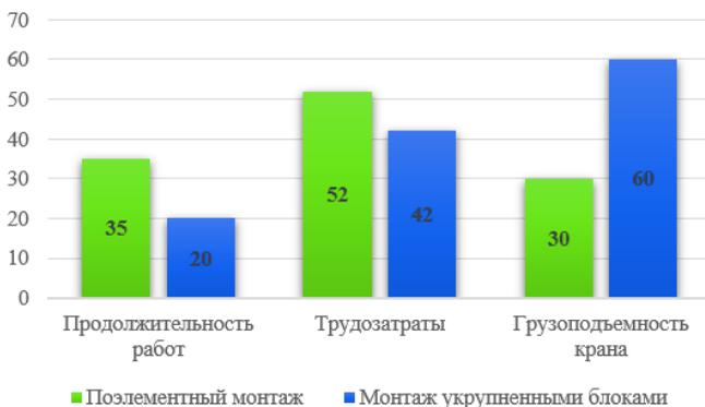
Рис. 2. Сравнительный анализ методов монтажа
