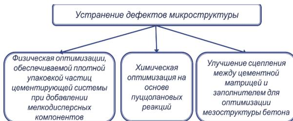
Рис. 1. Регулировка ударной прочности бетона на уровне микроструктуры
