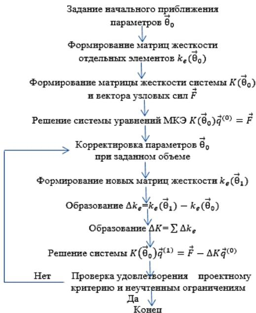
Рис.1 Алгоритм решения задачи структурного синтеза
