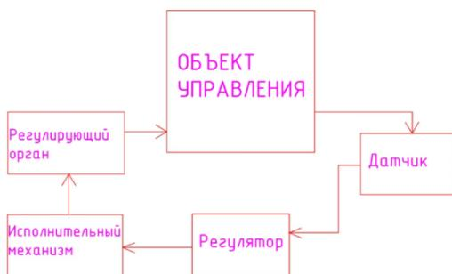
Рис.1. Типовая схема САУ системы промышленной вентиляции
