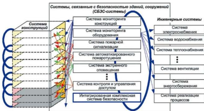
Рис. 1. Системы обеспечения безопасности зданий и сооружений
