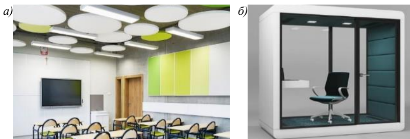
Рис. 1. Звукопоглощающие решения в интерьере: а – потолочная плита; б – акустическая кабина
