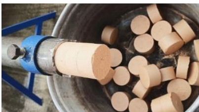
Рис. 3. Процесс изготовления брикетов опилок
