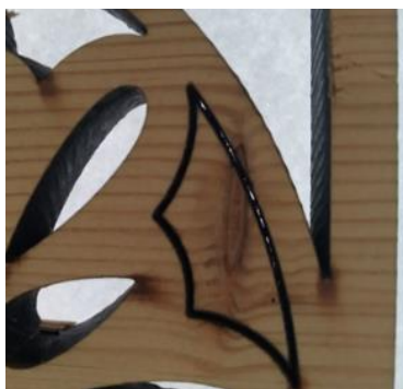
Рис. 2. Виды брака при лазерной резке древесины
