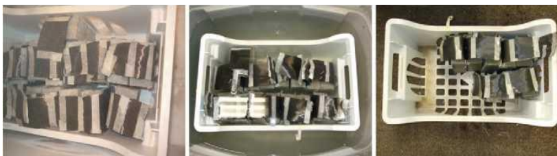
Рис. 2. Испытание на сдвиг бетонных образцов, усиленных полимеркомпозитами и находящимися в агрессивной среде
