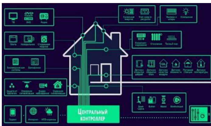
Рис. 2. Система умного дома с использованием проводных шин
