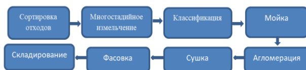
Рис. 2. Технология производства полимерного флекса для дорожного строительства
