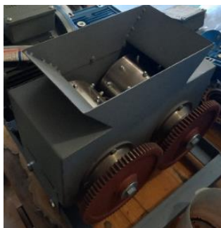
Рис. 2. Валковая дробилка с шипованными валками
