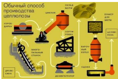
Рис. 2. Процесс переработки древесины в целлюлозу
