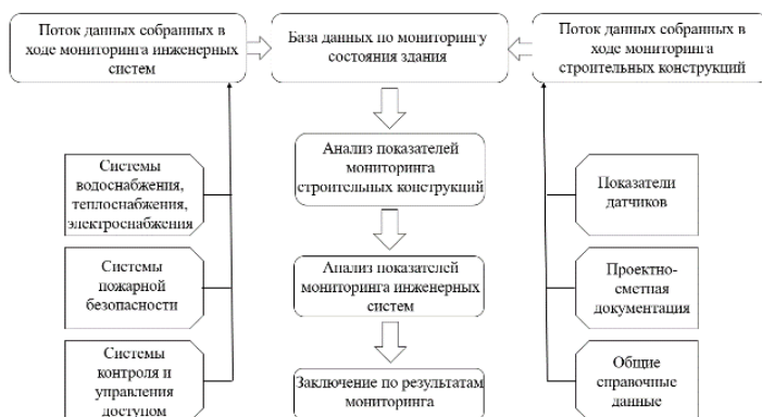
Рис. 2. Общая схема информатизации мониторинга здания
