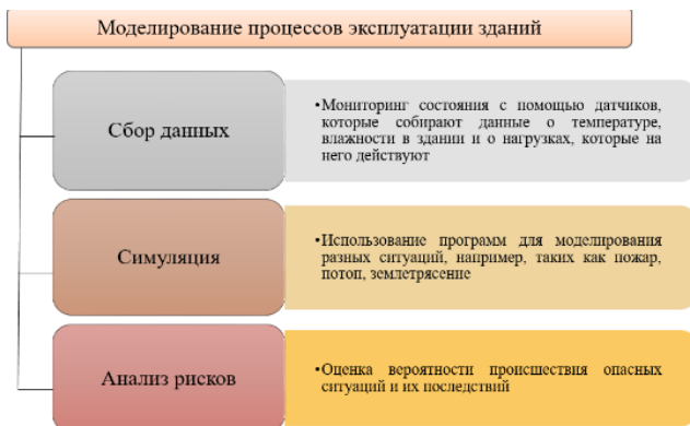
Рис. Моделирование процессов эксплуатации зданий
