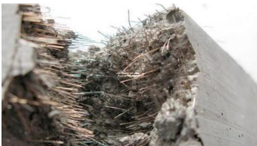
Рис. 1. Фибробетон (вид в разрезе) с добавлением металлической фибры
