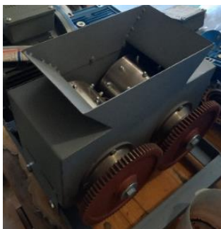
Рис. 2. Валковая дробилка с шипованными валками
