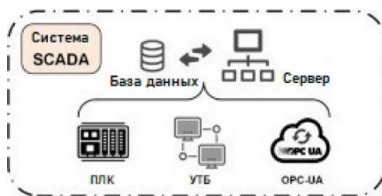
Рис. 4. Сервер диспетчерского управления и сбора данных (SCADA)
