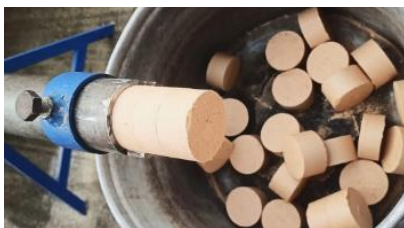
Рис. 3. Процесс изготовления брикетов опилок
