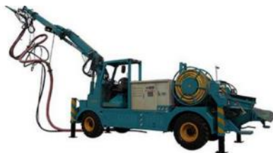
Рис. 2. Система торкретирования GSC-2515
