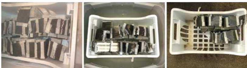
Рис. 2. Испытание на сдвиг бетонных образцов, усиленных полимеркомпозитами и находящимися в агрессивной среде
