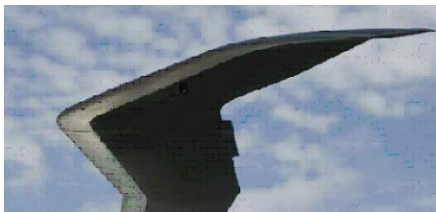
Рис. 3. Изменяемая геометрия лопасти по технологии Blue Edge
