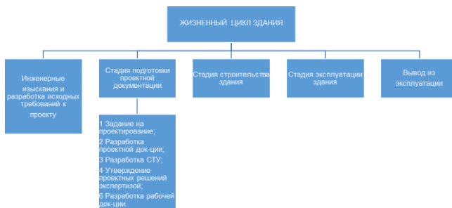
Рис. 1. Жизненный цикл здания
