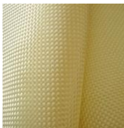
Рис. 2. Армирующая ткань из арамидных волокон – кевлар
