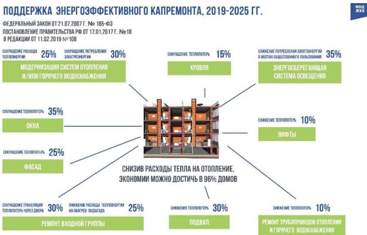
Рис. 1. Основные направления работ при проведении энергоэффективного капитального ремонта при поддержке фонда реформирования ЖКХ
