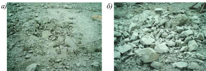
Рис. 1. Видимая воронка взрыва скважин: а – без применения забойки; б – с применением забойки
