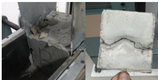
Рис. 2. Два различных типа разрушения образцов с выкалыванием бетона (слева), с горизонтальной трещиной (справа)
