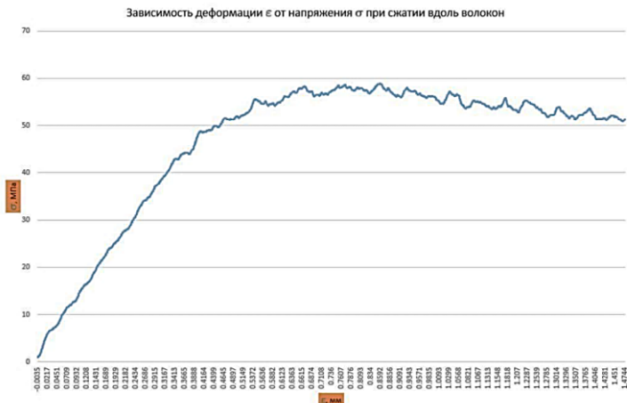
Рис. 1. Диаграмма «деформации-напряжения» при испытании на сжатие деревянной прямоугольной призмы размерами 20 \times 20 \times 30 см
