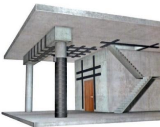
Рис. 1. Усиление конструкций композитными холстами и обоймой
