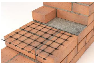
Рис. 3. Армирование кирпичной кладки композитной сеткой
