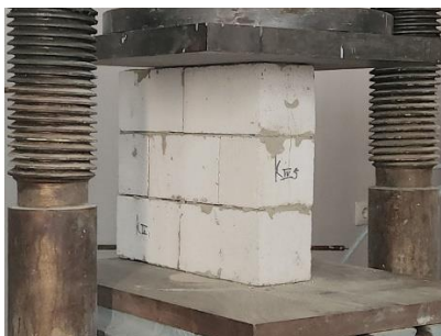
Рис. 2. Образец кладки на ЦПР после разрушения
