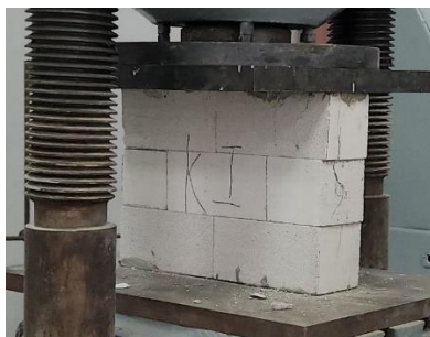
Рис. 3. Образец кладки на ПУ клею после разрушения
