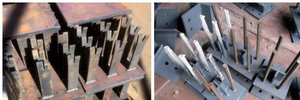
Рис. 3. Варианты исполнения закладных деталей с анкерами
