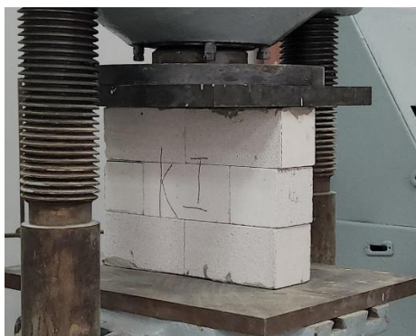
Рис. 1. Испытание образца кладки с ПУ швом
