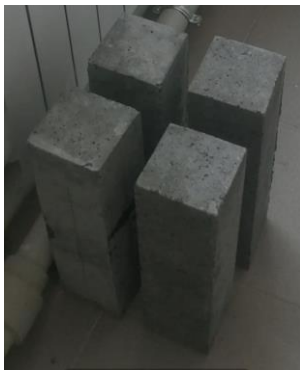
Рис. 1. Контрольные образцы-призмы из бетона с добавлением резиновой крошки
