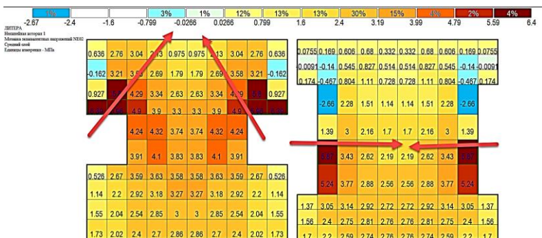
Рис. 3. Различный характер распространения возникающих напряжений в бетоне с наклонным (слева) и с горизонтальными (справа) направлениями возможного разрушения
