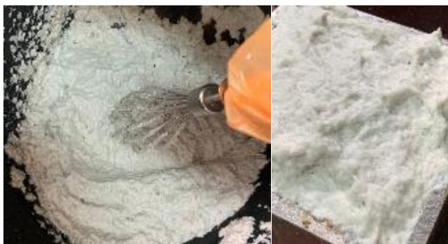
Рис. 2. Процесс вовлечения воздуха в массу смеси (слева), образец №2 в форме до снятия излишков (справа)
