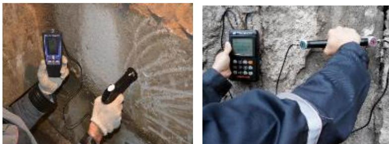
Рис. 5. Неразрушающий метод определения прочности бетонных конструкций
