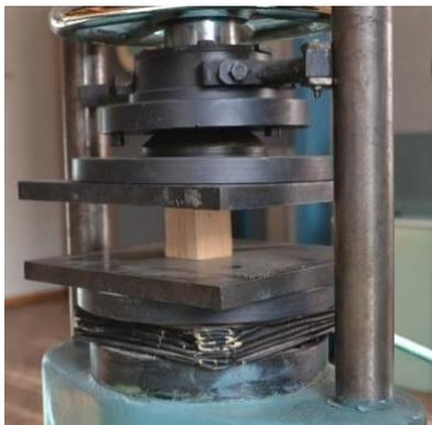
Рис. 1. Установка испытуемых образцов на опорных плитах гидравлического пресса ПСУ - 10
