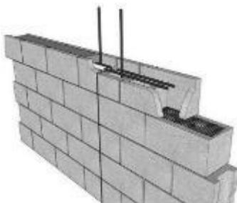
Рис. 3. Армирование шва элемента стены армированным пенобетоном
