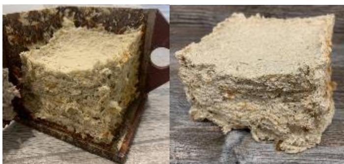
Рис. 3. Образец №2 после сушки в естественных условиях (слева), образец №2 после принудительной сушки (справа)
