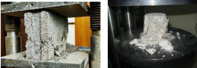
Рис. 4. Разрушающий метод определения прочности бетонных образцов
