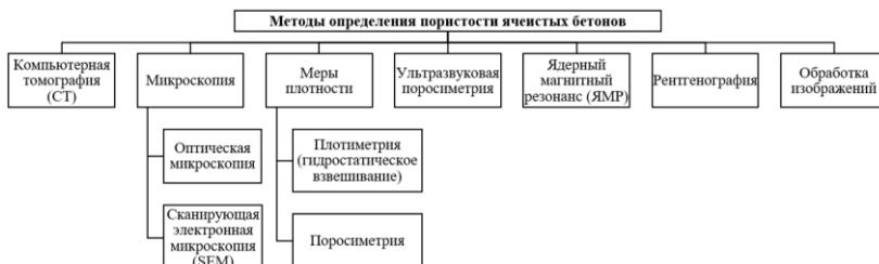
Рис. 1. Методы определения пористости ячеистых бетонов
