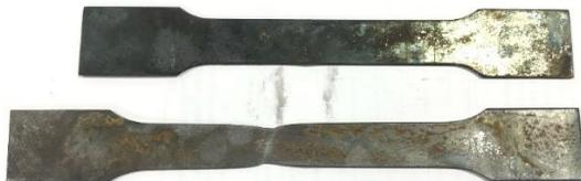
Рис. 2. Образцы конструкционной стали до и после испытания
