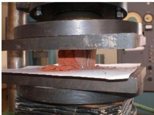
Рис. 2. Испытание на сжатие образца на прессе ПСУ – 10
