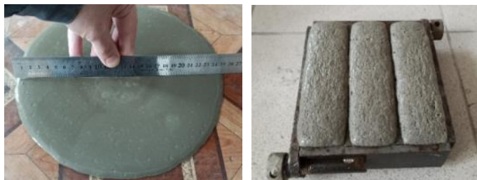
Рис. 2. Распływ газобетонной смеси и заполненная форма смесью с «горбушкой»
