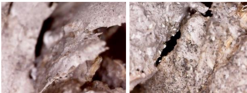
Рис. 2. Состояние поверхности композита с немодифицированным наполнителем
