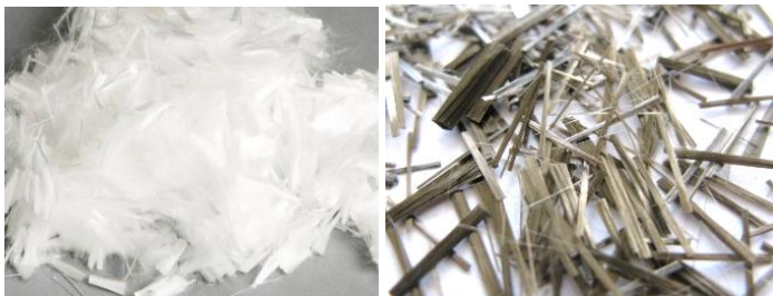
Рис. 1. Внешний вид волокон, полипропиленовое и базальтовое соответственно
