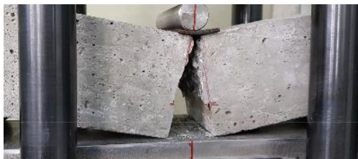
Рис. 4. Разрушение неармированного образца
