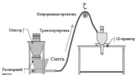
Рис. 2. Смешивание и перекачка пенобетона для непрерывной печати
