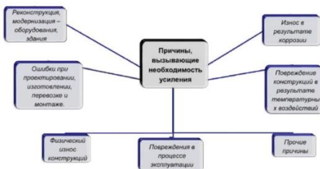
Рис. 1. Потребность в усилении несущей конструкции
