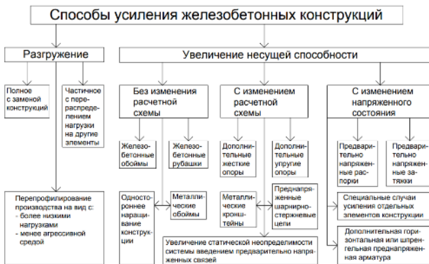
Рис. 2. Классификация способов усиления железобетонных конструкций
