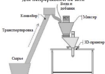
Рис. 4. Автоматическая и полностью интегрированная система смешивания пенобетона для непрерывной печати
