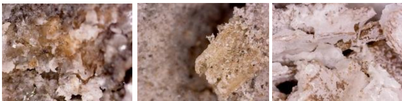
Рис. 1. Состояние поверхности композита с модифицированным наполнителем
