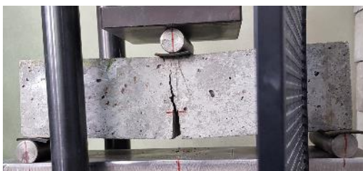
Рис. 5. Разрушение образца фибробетона со стальной спиралевидной фиброй
