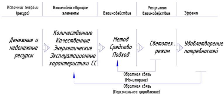
Рис. 2. Развернутая схема взаимодействия элементов в системе «Светотехнический режим»
