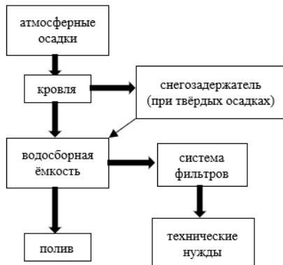
Рис. 2. Система установки накопления и использования атмосферных осадков
