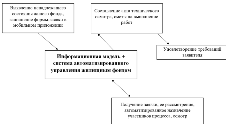
Рис. 7. Устранение неисправности с применением ТИМ-подхода
