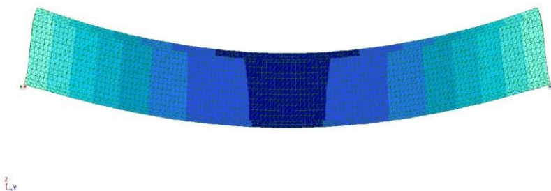
Рис.2 Изополя перемещений образца вдоль оси Z(мм) для оценки прогиба балки
