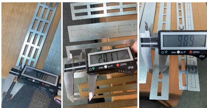
Рис. 2. Натурные замеры образцов стальных перфорированных лент
