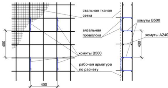
Рис. 1. Схема крепления металлической разделительной сетки к арматурному каркасу
