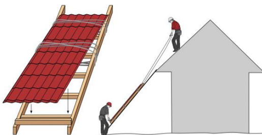
Рис. 3. Поднятие кровельных элементов ручным способом
