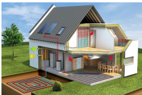
Рис. 1. Принцип работы систем в энергоэффективном доме на примере малоэтажного дома
