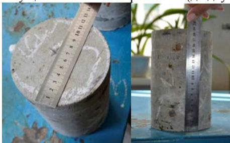
Рис. 2. Извлеченные из массива обследуемой монолитной фундаментной плиты бетонные образцы цилиндрической формы (керны)
