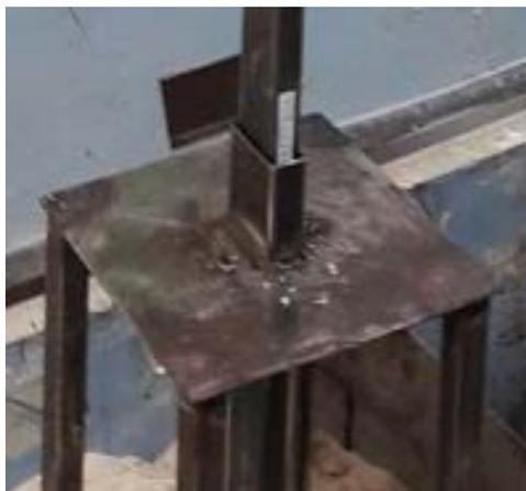
Рис. 8. Прибор со шкалой для измерения осадки сваи
