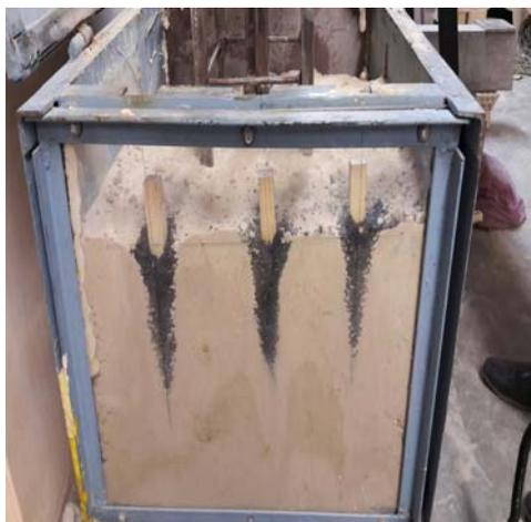
Рис. 6. Общий вид распределения наполнителя вокруг свай
