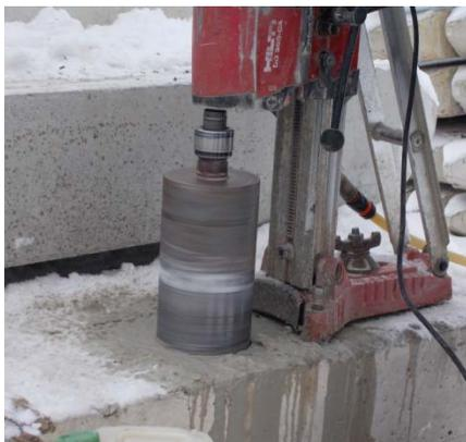
Рис. 1. Процесс отбора образцов-цилиндров бетона из свай С100.30-8
