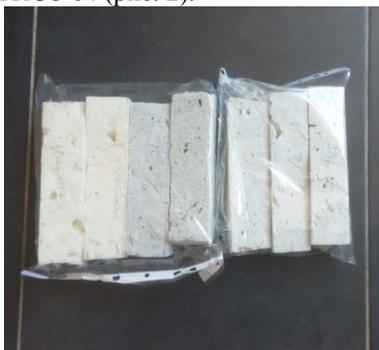
Рис. 1. Образцы пенополиуретана с различной концентрацией хвостов для испытаний на установке ОТМ
