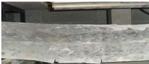
Рис. 2. Структура трещин в контрольных балках
