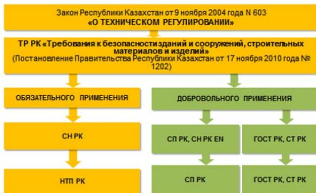
Рис. 4. Система технического регулирования в области строительства Республики Казахстан
