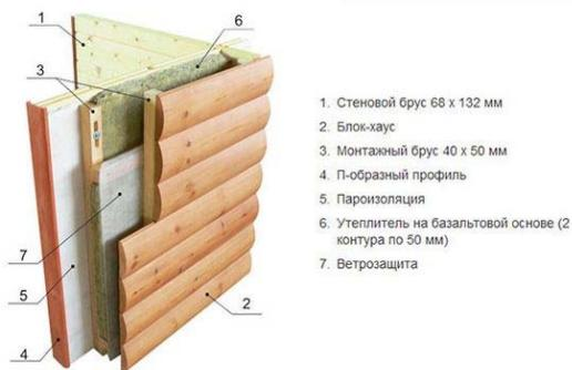
Рис. 2. Наружная облицовка стен с использованием блок-хауса
