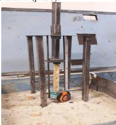
Рис. 3. Модель копровой установки
