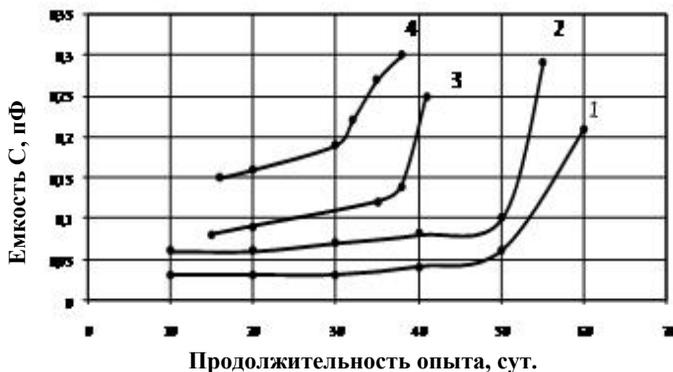
Рис. 1. Изменение во времени емкости электрода С для антикоррозионных композиций при частоте переменного тока 1000 Гц: 1 – модификатор ржавчины №3 + грунтровка ГФ-010; 2 – модификатор ржавчины №3 + грунтровка БТ-577; 3 – грунтровка ГФ-010; 4 – грунтровка БТ-577
