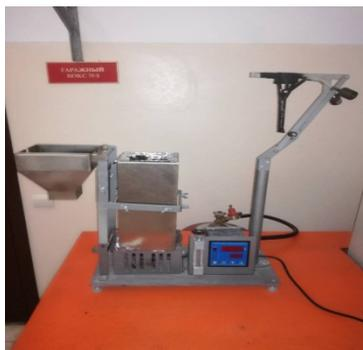
Рис. 2. Установка ОТМ для определения группы трудногорючих и горючих твердых веществ и материалов
