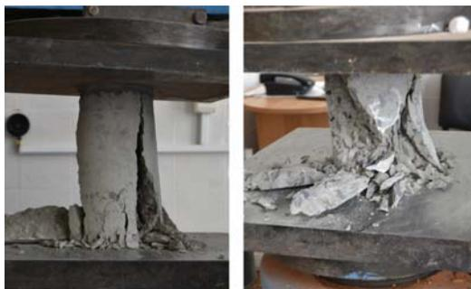
Рис. 3. Характер разрушения кернов, извлеченных из массива фундаментной плиты: слева — из верхней части плиты (характер разрушения неудовлетворительный), справа — из нижней части плиты (характер разрушения удовлетворительный)
