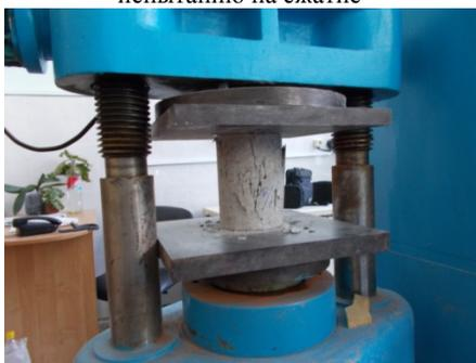
Рис. 3. Характер разрушения образцов при сжатии
