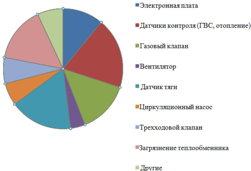
Рис. 1. Статистика неисправностей газовых отопительных котлов на примере работы организации ООО «ВИД»
