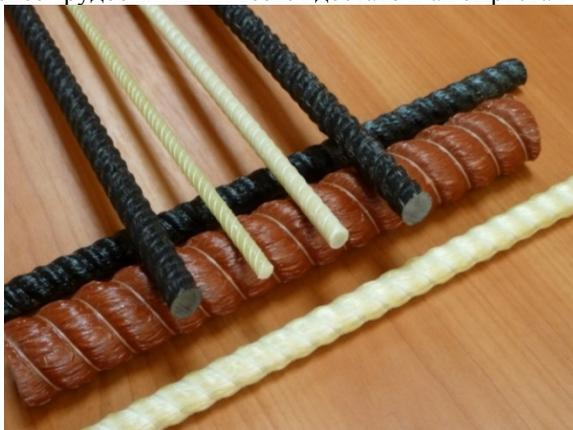
Рис. 1. Композитная арматура
