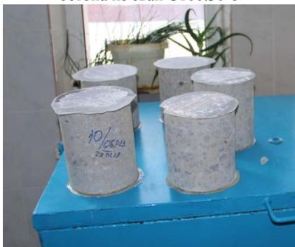
Рис. 2. Образцы-цилиндры бетона, подготовленные к испытанию на сжатие
