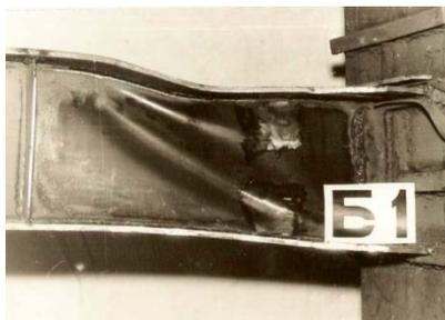
Рис. 7. Потеря общей устойчивости плоской стенки такой же толщины [40]
